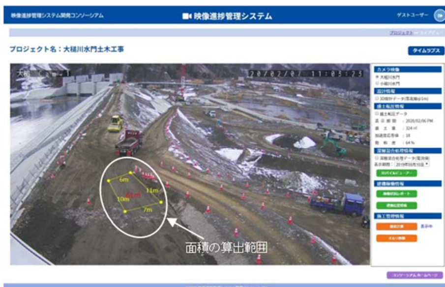
図4 システム画面（資材ヤードを想定した面積の算出）
