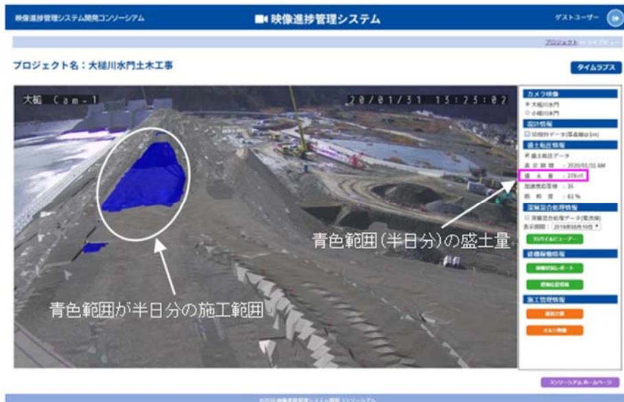
図3 システム画面（振動ローラのGNSSデータの重ね合わせ表示） ※昼の打合せ時に午前中の盛土の施工範囲とその施工量を確認
