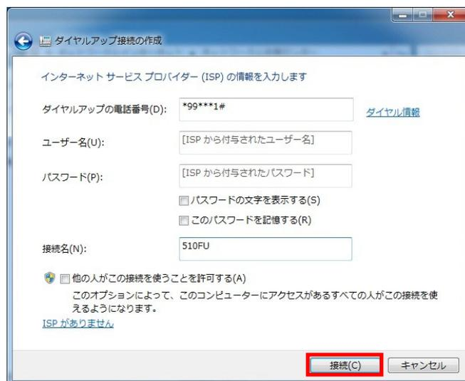
・「ダイヤルアップの電話番号」には、\*99\*\*\*<cid>#を入力します。<cid>には設定したプロファイルの CID を指定してください。
