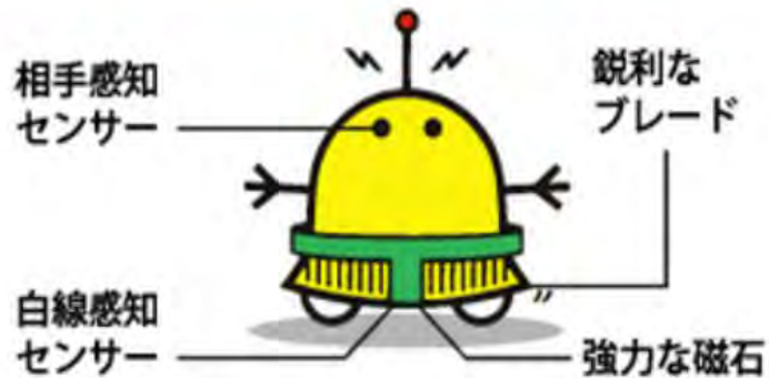
自立型力士 — コンピュータープログラムで戦うロボット —
